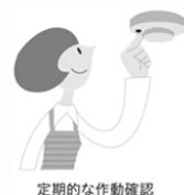
定期的な作動確認
