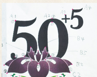
◀焼き抜く箇所・順番が細かく分けられた工程表。理屈で準備するからこそ、実際の作業を感覚的に行える。
