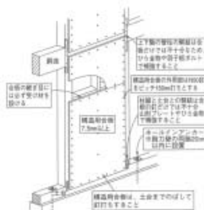
構造用合板による耐震補強
