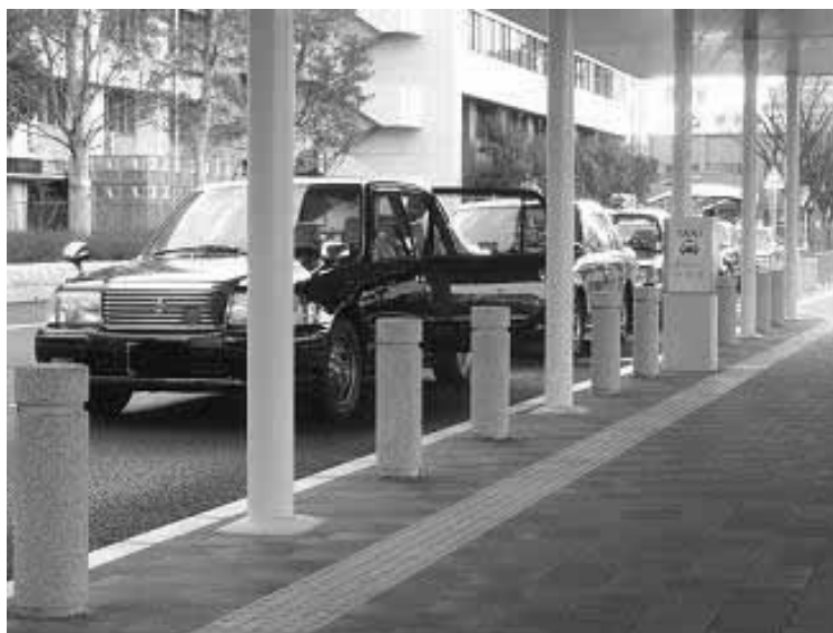
タクシー乗り場の整備例：歩道の段差を解消し上屋を併設。 また公共交通機関出入口から連続した視覚障がい者誘導用ブ ロックを敷設している。 (名古屋市内医療施設)
