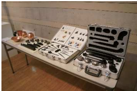
鬼頭 正信 KITOH Masanobu 「RT & RTG」 銅 「鍛金」技法で使う「当て金」の改良を研究してきた。その現状報告。
